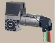
ELEKTROMATEN SE являются специальными приводами для промышленных ворот с весовым уравновешиванием. Монтаж осуществляется прямо на воротном валу. ELEKTROMATEN SE состоит из: червячного редуктора с полым валом, аварийного ручного привода, интегрированного конечного выключателя и электродвигателя.
