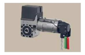
ELEKTROMATEN TSE являются специальными приводами для секционных ворот с весовым уравновешиванием и механическим ограничителем хода. Монтаж осуществляется, как правило, прямо на воротном валу. Устройства ELEKTROMATEN TSE состоят из: червячного редуктора с полым валом, аварийного ручного привода, интегрированного конечного выключателя с устройством управления Тотманн и двигателя переменного тока.
