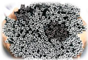
Термопластические эластомеры принципиально разделяются на две основные группы. Первую группу составляют блочные сополимеры, которые являются соединением в одной макромолекуле мягкой и жесткой фазы. Вторую группу составляют эластомерные смеси, в которых в гомогенном виде в виде молекул присутствуют мягкая и жесткая фазы (EPDM/PP). Данные две группы могут быть разделены на различные виды классов, исходя из структурных форм внутри основной группы.
