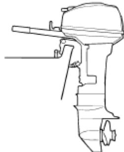
Подвесной мотор, закрепленный на транце лодки, должен транспортироваться в нормальном рабочем положении.
