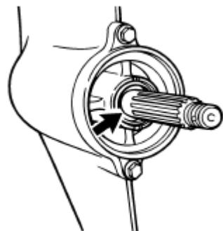
4. Сальники вала винта на наличие утечки масла из редуктора.
