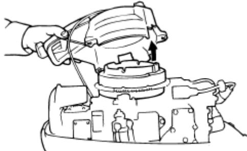
3. Выверните крепежные болты и снимите ручной стартер в сборе.
