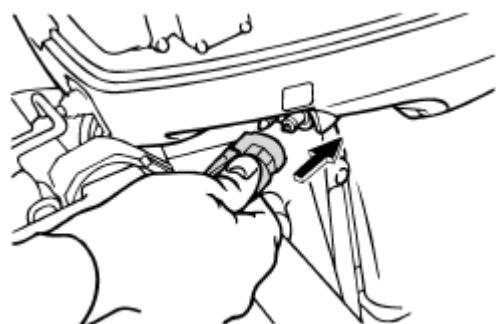
2. Надежно подсоедините топливный шланг к быстроразъемному штуцеру мотора.
