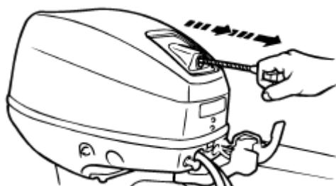
5. Для запуска двигателя потихоньку потяните на себя ручку ручного стартера, пока не почувствуете упор. Далее из этого положения резко тяните на себя ручку для проворачивания двигателя. Если потребуется повторите эту процедуру.
