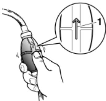
4. Поработайте насосом подкачки (грушей) топливного шланга держа его вертикально стрелкой вверх до тех пор, пока не почувствуете сопротивление. Убедитесь в отсутствии подтеков топлива.
