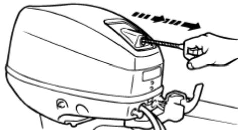
Для запуска двигателя потихоньку потяните на себя ручку ручного стартера, пока не почувствуете упор. Далее из этого положения резко тяните на себя ручку для проворачивания двигателя.
