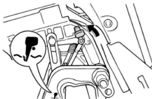
Переведите рычаг фиксатора мотора в нижнее положение.
