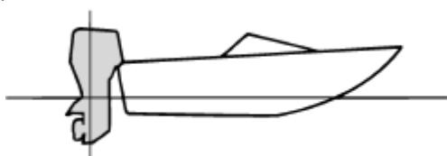
При слишком высоком подъеме носа из воды характеристики и экономичность двигателя снижаются, поскольку корпус судна толкает воду и создает большое лобовое сопротивление в воздухе. Избыточная величина подъема носа может также привести к захвату воздуха пропеллером, что еще больше ухудшает характеристики и может вызвать скачки судна в воде, способные сбросить водителя и пассажира за борт.
