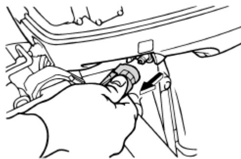
3. Отсоедините топливный шланг от мотора.
