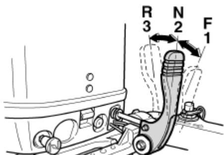
Чтобы перейти с нейтрали на передачу твердо и решительно переведите рычаг переключения передач вперед (для передней передачи), или назад (для задней передачи). Перед переводом рычага на заднюю передачу не забудьте убедиться в том, что рычаг фиксатора наклона находится в нижнем (фиксированном) положении. В противном случае мотор будет стремиться подняться из воды.
