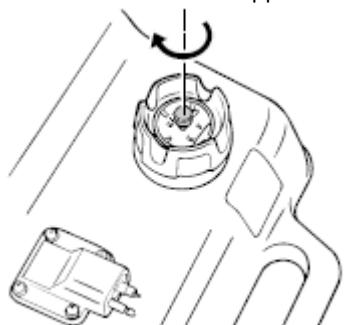
2. Закройте вентиляционный клапан топливного бака, закрутив его винт по часовой стрелке.
