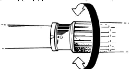
Поворачивайте ручку против часовой стрелки для увеличения оборотов двигателя (скорости судна) и по часовой стрелке для уменьшения оборотов двигателя (скорости судна).
