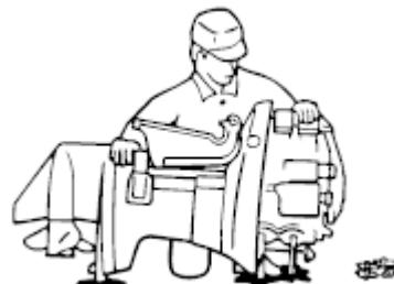
2. Выверните свечи зажигания и поставьте мотор свечными отверстиями вниз, что бы дать стечь всей воде, илу, или грязи из внутренней полости двигателя.
