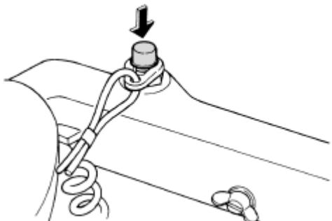
1. Нажмите кнопку остановки двигателя и удерживайте ее в нажатом состоянии, пока двигатель полностью не остановится.
