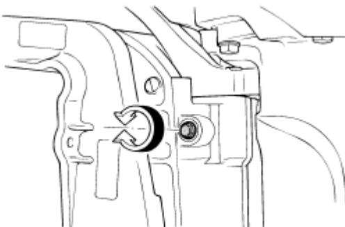
Данное устройство обеспечивает регулируемое сопротивление рулевого механизма и может быть настроено в соответствии с предпочтениями водителя. Регулировочный болт располагается на поворотном кронштейне с левой стороны мотора. Для увеличения сопротивления вращайте болт по часовой стрелке. Для уменьшения сопротивления против часовой стрелки.
