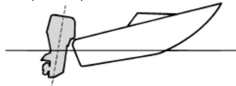
Слишком большая величина опускания носа вызывает тяжелое продвижение судна в воде, снижает топливную экономичность и затрудняет разгон. Эксплуатация с чрезмерной величиной опускания носа на высоких скоростях делает также судно неустойчивым. Сопротивление движению судна значительно увеличивается, повышается опасность зарываивания носом, а эксплуатация становится сложнее и опаснее.
