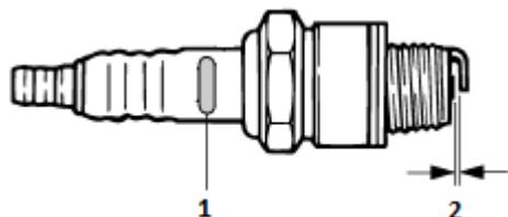
Перед установкой свечи зажигания, с помощью щупа, измерьте величину зазора между ее электродами. Если необходимо - отрегулируйте зазор в соответствии со спецификацией.
