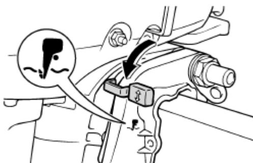
Затем переведите рычаг фиксатора мотора в нижнее положение.
