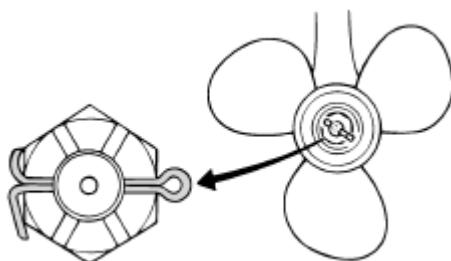
4. Доверните гайку, используя деревянный брускок подходящего размера и гаечный ключ, до совмещения отверстий в валу винта и на гайке. Вставьте новый шплинт в отверстие и разогните его лапки.
