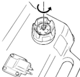
1. Выверните винт вентиляционного клапана на 2 – 3 оборота.
