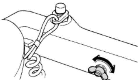
Данное устройство создает регулируемое сопротивление вращению ручки румпеля и может настраиваться по желанию водителя. Для увеличения сопротивления вращайте винт устройства по часовой стрелке, для уменьшения сопротивления вращайте винт устройства против часовой стрелки.
