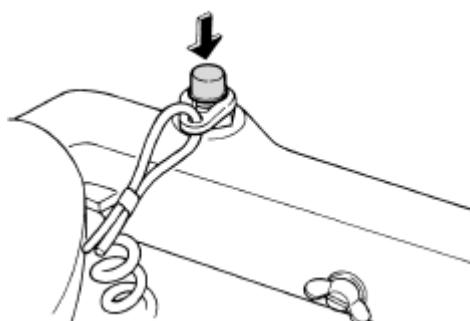
Чтобы заглушить двигатель не снимая чеки безопасности, нажмите на кнопку остановки двигателя.
