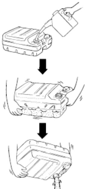
2. Залейте в бак небольшое количество чистого бензина, установите пробку на заливную горловину и встяжните бак. Полностью слейте бензин из бака.
