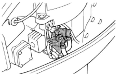
1. Снимите топливный фильтр в сборе, отцепив от него топливные трубы и открутив гайку крепящую фильтр к кронштейну.
