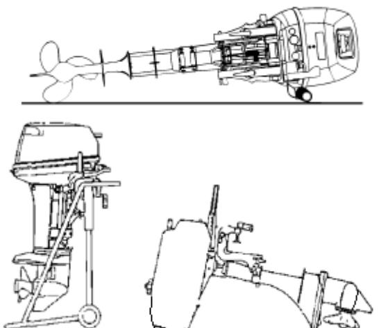
При перевозке или хранении подвесного мотора снятого с судна, держите мотор в показанном положении.
