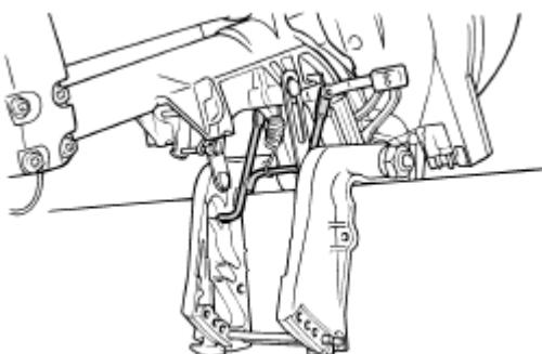
Данный упор держит лодочный мотор в одном из поднятых положений.
