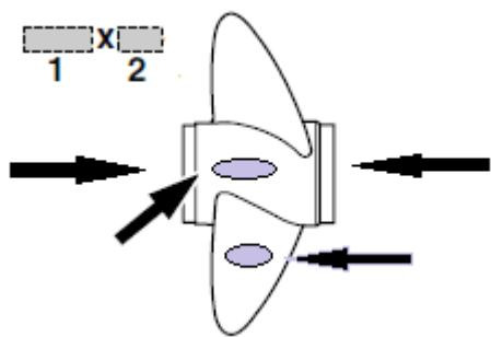
Стрелками указаны наиболее вероятные места маркировки пропеллеров разных производителей.
