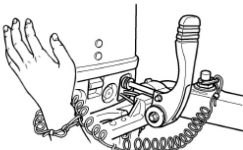
2. Вставьте чеку безопасности в кнопку остановки двигателя. Второй конец шнура безопасности закрепите на своей одежде, либо руке или ноге.
