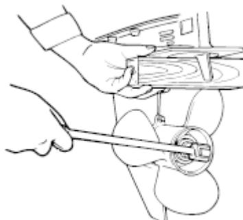
2. Используя деревянный брускок подходящего размера, от проворачивания винта, открутите гайку и снимите шайбу.
