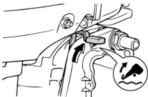
2. Переведите рычаг фиксатора мотора в верхнее положение
