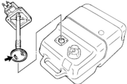
4. Промойте и высушите фильтр находящийся на трубе топливоприемника.
