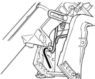
3. Немного приподнимите мотор, пока не услышите, как упор для поддержания мотора вошел в фиксатор соответствующий движению по мелководью.
