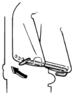
Данный штифт нужен для регулировки угла наклона (угла атаки) мотора относительно транца лодки.
