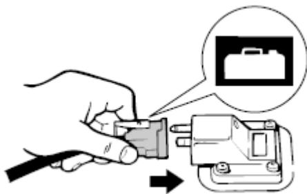
3. Затем также надежно подсоедините топливный шланг к быстроразъемному штуцеру топливного бака.
