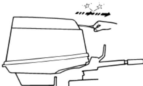
5. Для запуска двигателя потихоньку потяните на себя ручку ручного стартера, пока не почувствуете упор. Далее из этого положения резко тяните на себя ручку для проворачивания двигателя. Если потребуется, повторите эту процедуру.
