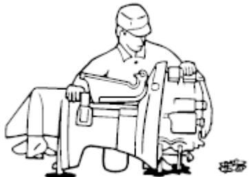
2. Выверните свечи зажигания и поставьте мотор свечными отверстиями вниз, что бы дать стечь всей воде, илу, или грязи из внутренней полости двигателя.
