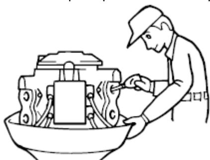
4. Проворачивая двигатель ручным стартером или шнуром аварийного запуска, залейте моторное масло в картер двигателя через карбюратор и в цилиндры через свечные отверстия.
