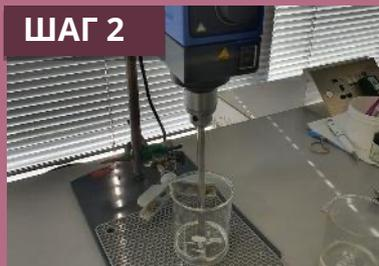
Перенесите Micromulse™ LB в верхнеприводную лопастную мешалку и установите высокую скорость (1000 об / мин).
