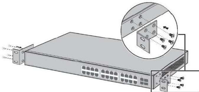
Затем закрепите коммутатор в стойке
