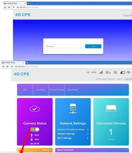
Для доступа к модему используем IP адрес **192.168.100.1**, пароль «**admin**». Для доступа к камере используем IP адрес **192.168.100.168**, логин «**admin**» и пароль «**наименование wi-fi сети камеры**». Главная страница показывает статус подключения к интернету, информацию об уровне сигнала, режим подключения к сотовой связи, количество Wi-Fi клиентов, информацию о Sim-карте и SMS.
