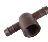
PLD-075-TBTEE Тройник. Трубная вставка 17 мм x внутренняя резьба 3/4"
