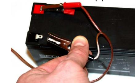
К инкубатору подключается резервное питание (аккумулятор) с помощью зажимов типа «крокодил».
