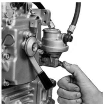
Прокачивайте топливную систему при помощи подкачивающего насоса, пока не будет выходить чистое топливо без пузырьков.
