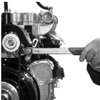
Затяните фиксирующий болт, с усилием 30 Н/м для болтов с резьбой 8 x 1.25 и 50 Н/м для болтов с резьбой 10 x 1.50.в 30 - 50 Н/м.
