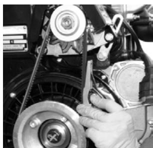
Также можно использовать измеритель натяжения генераторного ремня.
