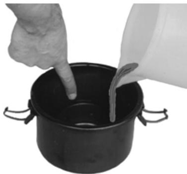
Залейте моторное масло до верхней отметки стакана фильтра.
