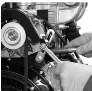
С усилием надавите на генератор в направлении от двигателя и затяните фиксирующий болт, с усилием 30 Н/м для болтов с резьбой 8 x 1.25 и 50 Н/м для болтов с резьбой 10 x 1.50.
