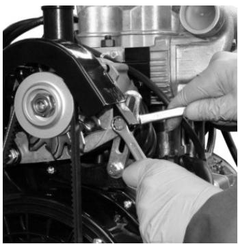
Открутите фиксирующие болты генератора.
