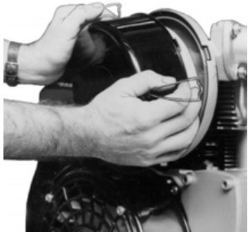
Откройте корпус фильтра и извлеките верхний фильтрующий элемент.
