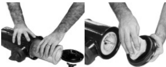
Откройте воздушный фильтр и извлеките фильтрующий элемент. Произведите очистку внутренней части корпуса. Соберите фильтр.
