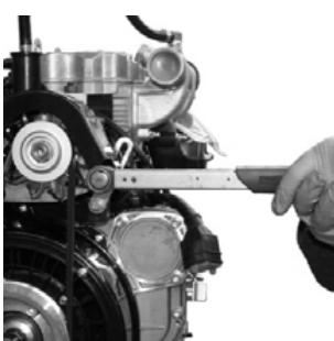
Закрутите болты фиксации генератора, с усилием 30 Н/м для болтов с резьбой 8 x 1.25 и 50 Н/м для болтов с резьбой 10 x 1.50.
