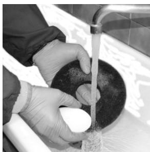
Промойте фильтрующий элемент с помощью мыла и воды.
