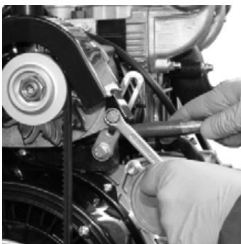
Отклоните генератор с необходимым усилием и затяните фиксирующий болт.
