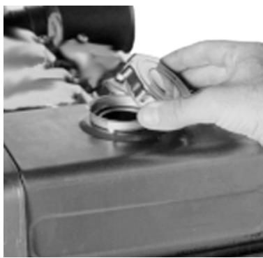
Откройте крышку топливного бака.
