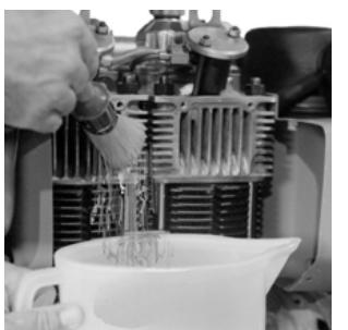
Если ребра охлаждения сильно загрязнены, очистите их с помощью кисти смоченной в дизельном топливе.
