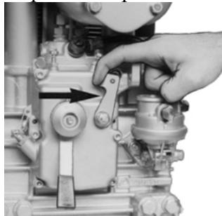
Для электроагрегатов предварительно отключите всю электрическую нагрузку.
