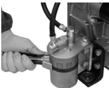
Снимите топливный фильтр с помощью специального инструмента.
