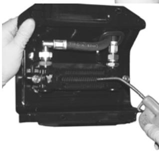
Просушите ребра сжатым воздухом.
