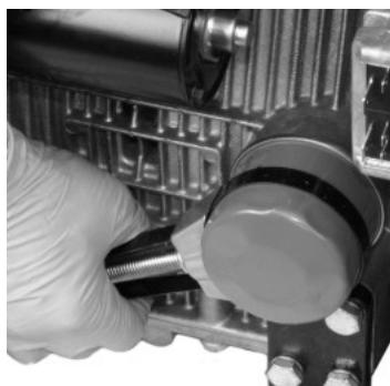
Снимите и замените масляный фильтр новым. Проверьте резиновое уплотнение на повреждение. Установите масляный фильтр. Затяните фильтр рукой.
