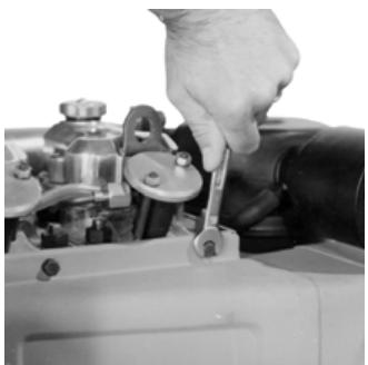
Снимите защитный кожух.
