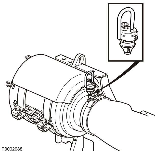
Двигатель оснащен электронным индикатором состояния воздушного фильтра. По сигналу блока управления формируется предупреждение на приборной панели. Предупреждение свидетельствует о перепаде давления в воздушном фильтре, что требует проверки фильтра и, возможно, его замены.
