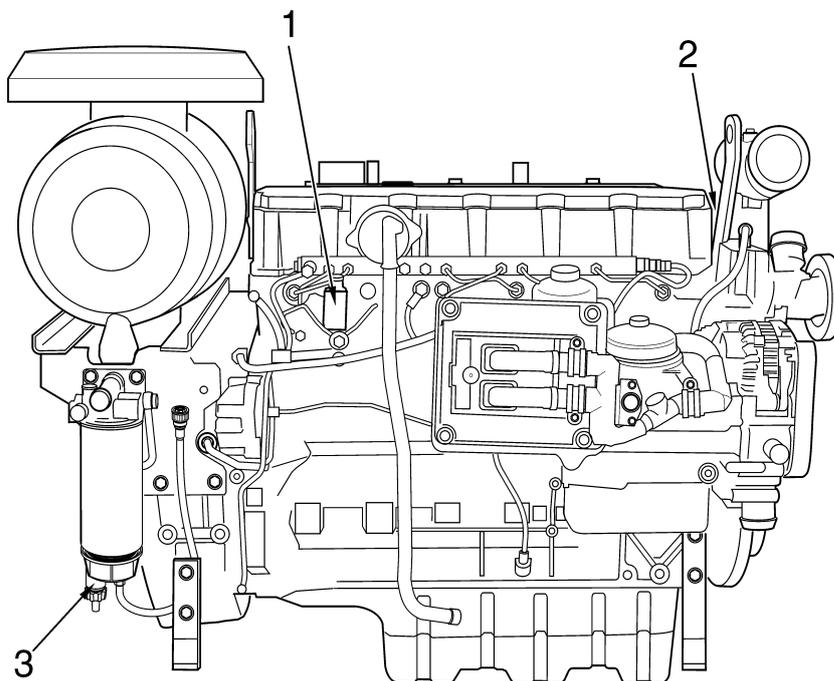
1. Электромагнитный пропорциональный клапан, насос высокого давления – топливо (MPROP)
