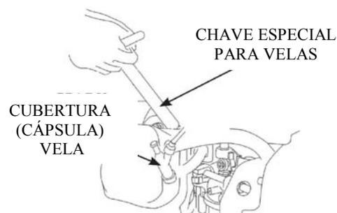
4. Analise a vela para verificar se o seu revestimento não apresenta fissuras ou fendas. Se o estado da vela não for satisfatório, substitua-a.
