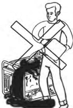
No exceda el máximo nivel de combustible durante el llenado del depósito.
