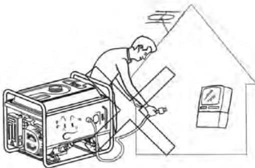
Nicht direkt an die Energieversorgung im Haushalt anschließen.
