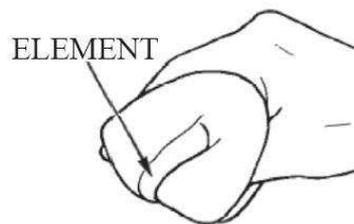
3. Установите обратно элемент воздушного фильтра и закройте крышку.
