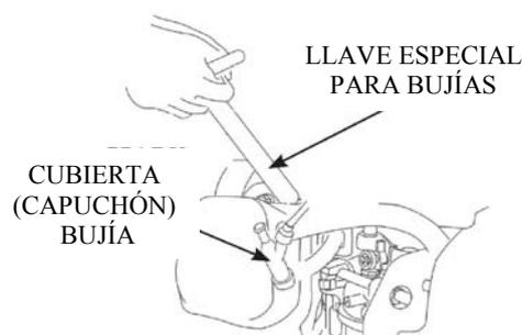
4. Inspeccione la bujía para comprobar que el cuerpo de su aislamiento no presente fisuras ni grietas. Si no se satisface esta condición, sustituya la bujía.
