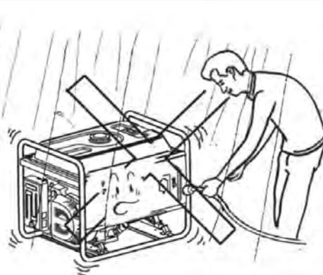
Não utilize o aparelho em condições de humidade extrema.
