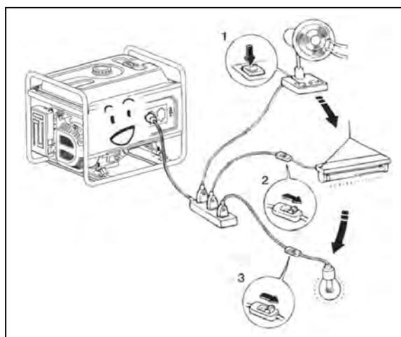
Если генераторная установка связана со многими нагрузками или электрическими приборами, пожалуйста, сначала подключите нагрузку с максимальным током потребления, затем - со вторым, и в заключение, с минимальным током потребления.
