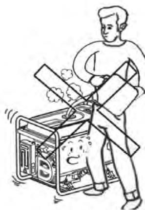
Pare el motor antes de cargar combustible en el depósito.
