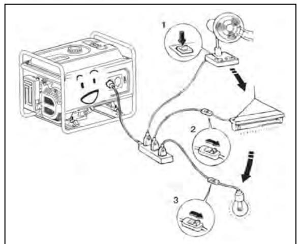
En général, les engins motorisés avec charge capacitive et inductive, surtout, présentent une charge élevée au démarrage.
