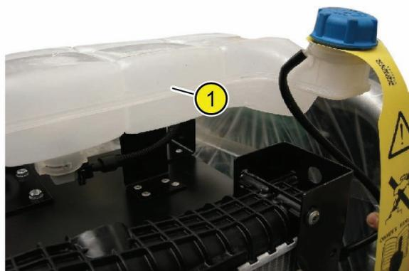
В генераторах типа SOUNDPROOF доступ к расширительному бачку осуществляется через крышку (2), находящуюся на верхней части кожуха.
