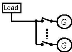
с) Генераторный агрегат (G), подключённый параллельно с сетью энергоснабжения общего пользования, от которой, параллельно с генераторным агрегатом, питается нагрузка (LOAD). Также в этом случае электрощит должен быть оснащён разъёмом для параллельного подключения. Ниже приводится пример блок-схемы:
