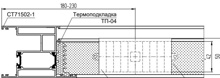
Подкладки КПП-10-04 + КПП-87
