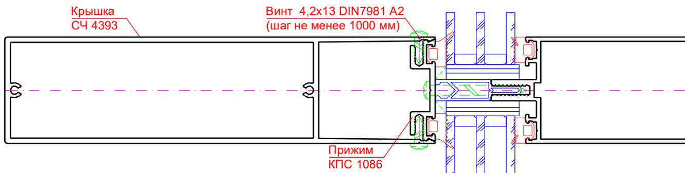
**Выполнение обработки крышки СЧ 4393**
