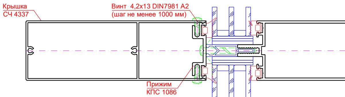
**Выполнение обработки крышки СЧ 4337**
