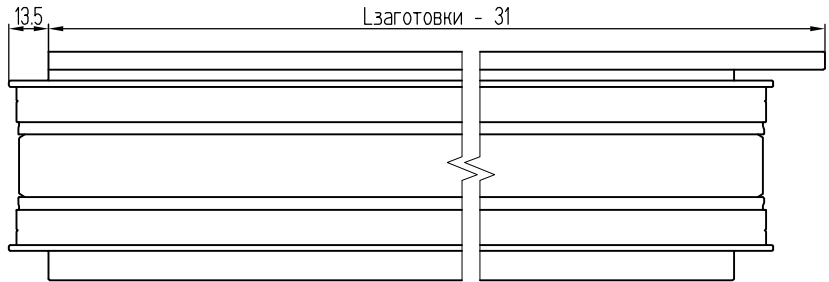
Обработка перекладины "ленивой" створки двери КПП7807
