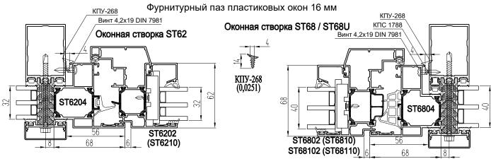
Базовые варианты установки "теплых" дверей ST62, ST68
