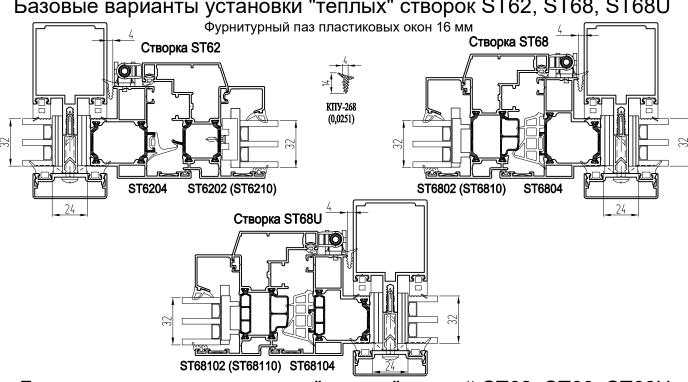
Базовые варианты установки "теплых" дверей ST62, ST68, ST68U
