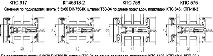
По подкладкам: винты 5,5х70 DIN7504K, штапик Т50-04 по длине подкладок, подкладки КПС 1126, КПП-18-1, КПП-28-1
