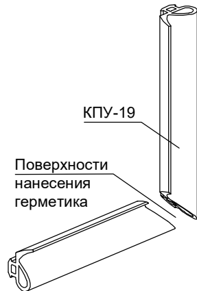
Вариант установки уплотнителей внешнего контура с разделкой горизонтальных и вертикальных деталей под углом 45°
