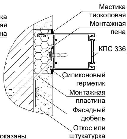
Вариант монтажа двери с помощью монтажных пластин
