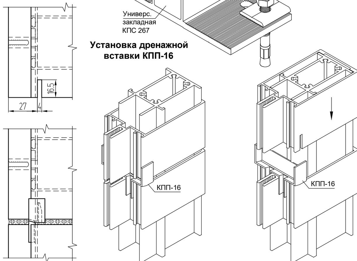
1. Влагоотвод из зоны фальца стеклопакета осуществляется за счет фрезеровки профиля ригеля уступом и отведения влаги из канавки ригеля в канавку стойки.
