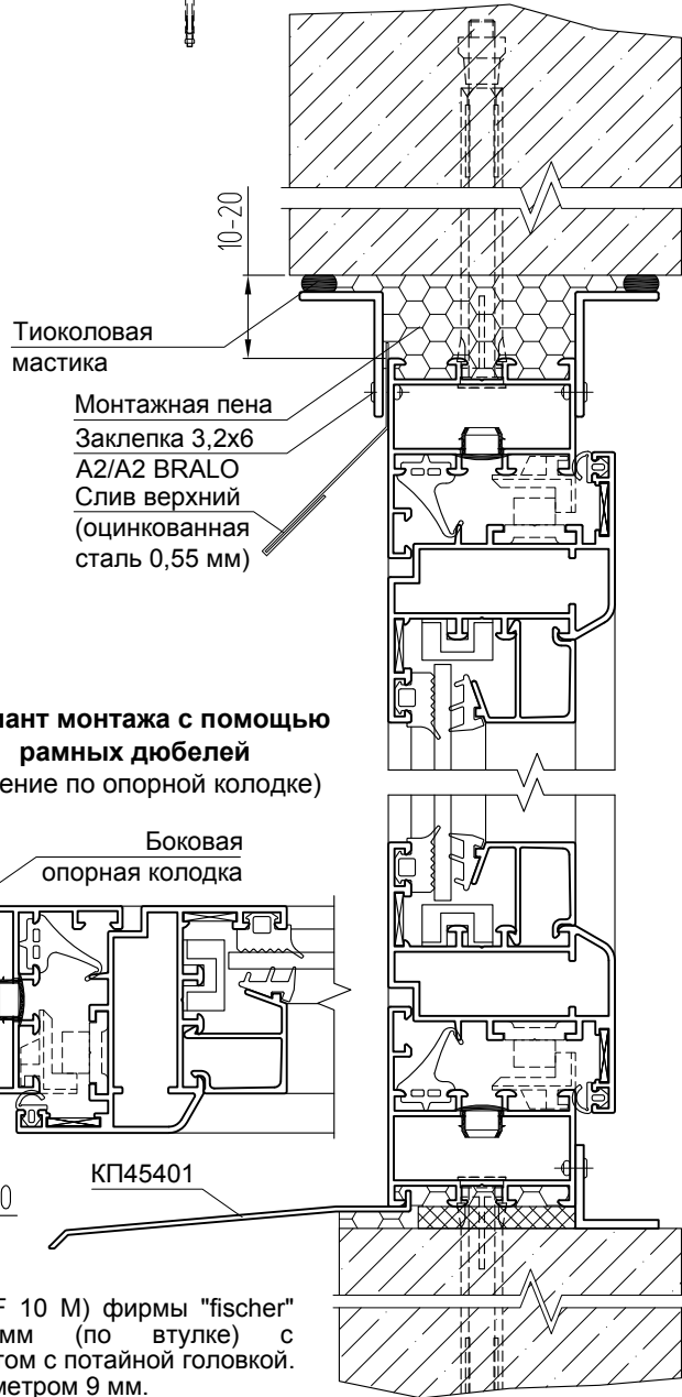
Вариант монтажа с помощью рамных дюбелей
