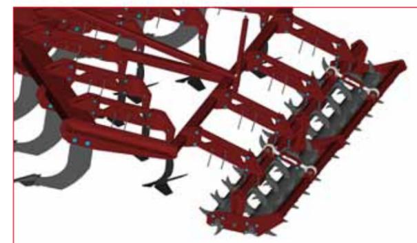
● Регулировка глубины обработки переднего и заднего ряда независима друг от друга. Осуществляется пальцами на параллелограмме крепления катка для передних лап и на параллелограмме крепления заднего ряда лап.
