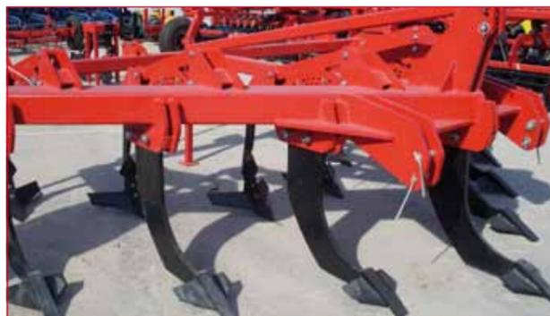
● Орудия оснащаются мощными передними стойками высотой 800 мм, с защитой через срезной болт.
