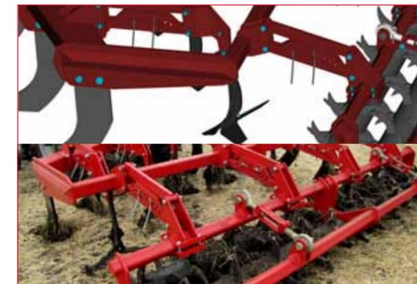
● Стойки могут снаряжаться двумя видами лап: долотообразными для щелевания или стрельчатыми для отрыва и подъема пласта, т.е. можно производить сплошное или полосовое рыхление.
