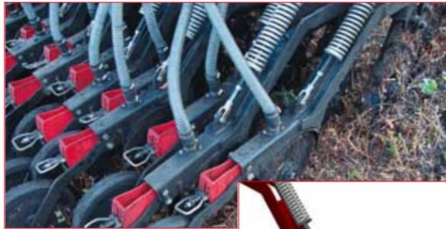
● Регулировка глубины хода сошниковых дисков осуществляется механизмом регулирования, если усилие пружины увеличивается, — сошниковые диски могут разрезать более твердый почвенный фон.
