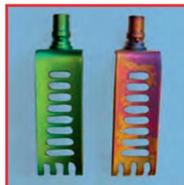
Участок – шины из титана: Левая шина – новая, с завода. Правая шина – после машинной очистки.
