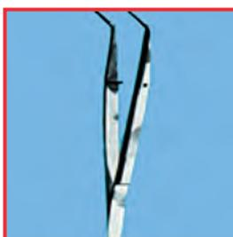
Частичное травление и отложения прижигающего средства для остановки кровотечения на поверхности инструмента. Причина: длительный контакт
