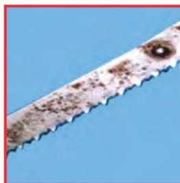
Коррозия материала частично нарушенного хромированного слоя. Причина: влага вызывает ржавление незащищенного несущего материала из обычной стали
