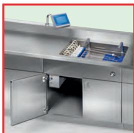
Ультразвуковой прибор, установленный в рабочей зоне
