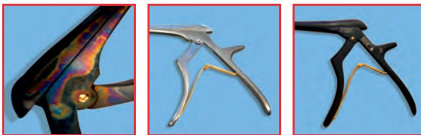
Пример: черный перфоратор с покрытием TiAlN. Разноцветное изменение окраски или полное отсутствие покрытия с неповрежденными позолоченными компонентами (концевой винт, пружины).
