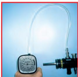
Ручная проверка герметичности гибкого эндоскопа
