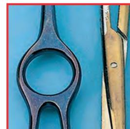
Типичное окрашивание силикатами в промывной камере и на поверхности инструментов из-за применения моющего средства, содержащего силикаты, или повышенного содержания кремниевой кислоты в воде.
