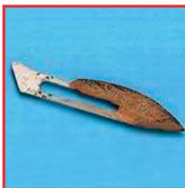
Коррозия материала поверхности лезвия под действием влаги. Причина: состав материала, обычная сталь, так как одноразовый инструмент.
