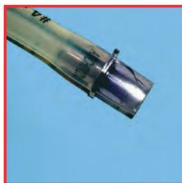
Трещина вследствие напряжений
