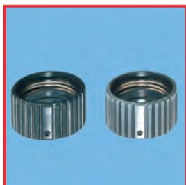
Изображение справа: повреждение материала умягченной водой.
