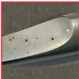
Язвенная коррозия инструмента под действием хлоридов.
