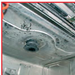
Промывная камера с сильной накипью
