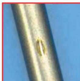
Контактная коррозия: нержавеющая сталь/нержавеющая сталь
