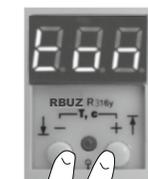
При включении устройство сразу начинает отображать значение напряжения сети. Если напряжение находится в допустимых пределах, включается нагрузка, и начинает светиться зеленый светодиод. Если напряжение сети превышает верхний предел или ниже нижнего предела, тогда напряжение на нагрузку не подается.
