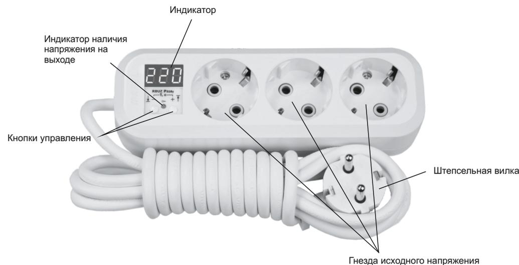
Также необходимо учитывать, что нагрузка в 3 000 ВА (при 220 В) при 270 В будет составлять 4 400 ВА. Поэтому при выборе подключаемой мощности нужно, чтобы при максимальном возможном напряжении (отклонения в верхнюю сторону) максимальная мощность, подключаемая к RBUZ, не превышала паспортного значения.
