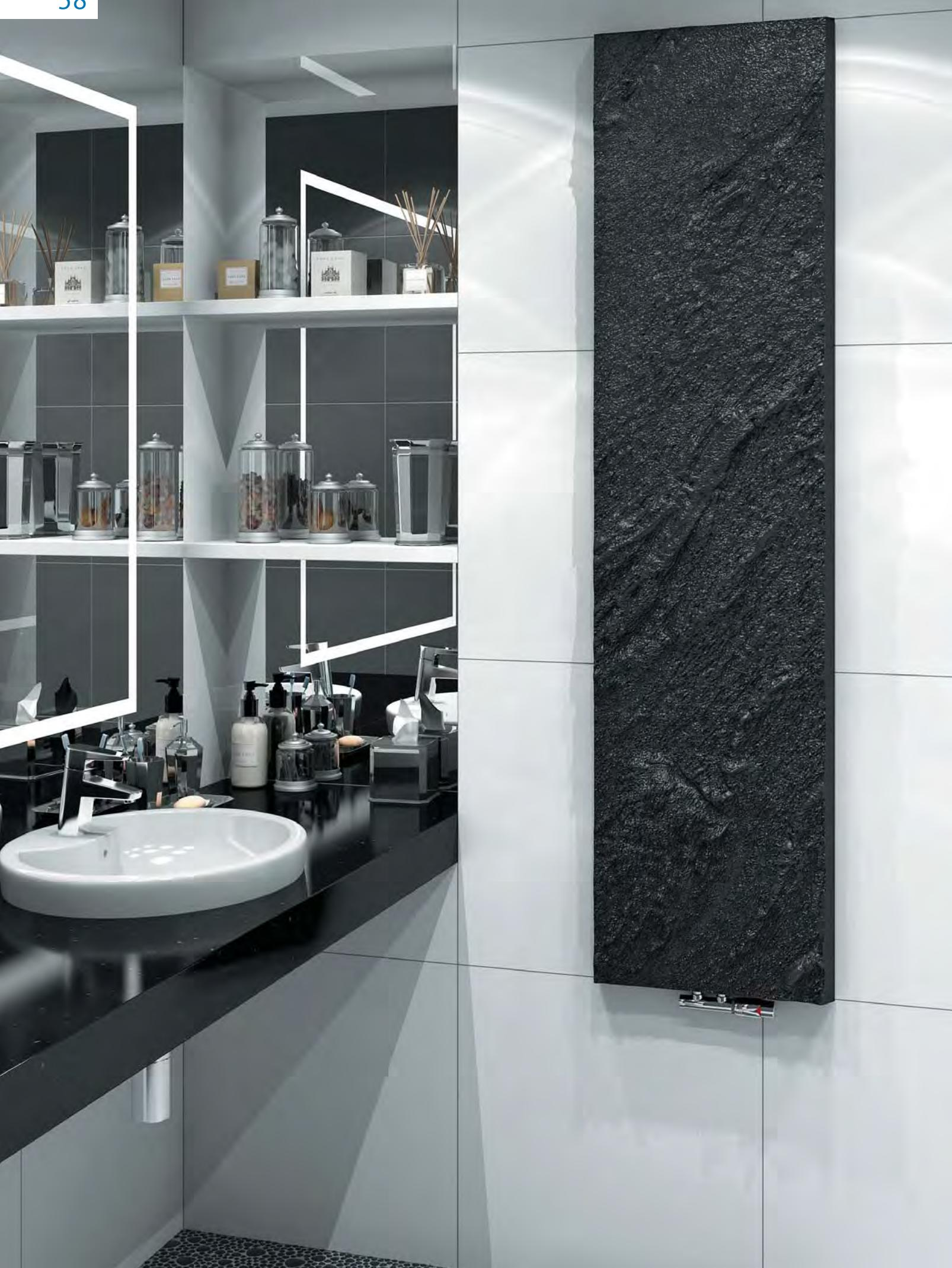
Лицевая панель радиатора «Solido Stone» изготавливается по уникальной технологии из материала на основе натурального камня. Нагревающая панель состоит из системы алюминиевых профилей с запрессованными в них медными трубами. Радиатор можно эксплуатировать в системе центрального отопления. Рабочее давление – 16 бар, опрессовочное – 24 бара.
