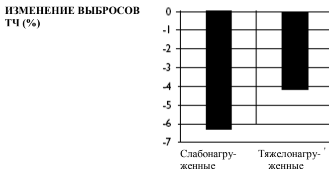
Рисунок 11: Влияние суммарного содержания ароматических углеводородов на выбросы ТЧ, при снижении объемной доли полиароматических углеводородов (ди-) с 9% до 1%
