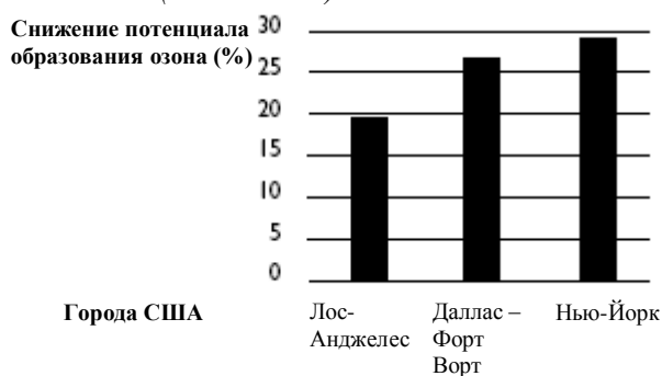
Рисунок 10: Снижение потенциала образования озона при снижении объемной доли олефиновых углеводородов в топливе (с 20% до 5%)
