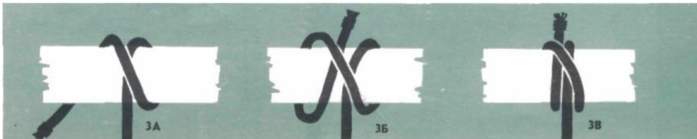
**4. Шлюпочный узел.** Если яхту понадобится буксировать, то закрепим буксирный конец шлюпочным узлом за мачтовую банку.
