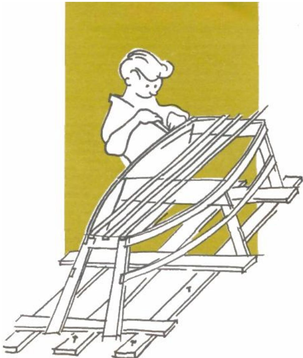
Для установки кипя (деталь 4) с помощью пилы и стамески на днищевой части транцев и мидель-шпангоута проделаем гнезда, соответствующие поперечному размеру киля (16Х85 мм). Гнезда должны находиться на диаметрали яхты. Когда продольное направление киля установлено, закрепим его окончательно с помощью клея и двух-трех шурупов.
