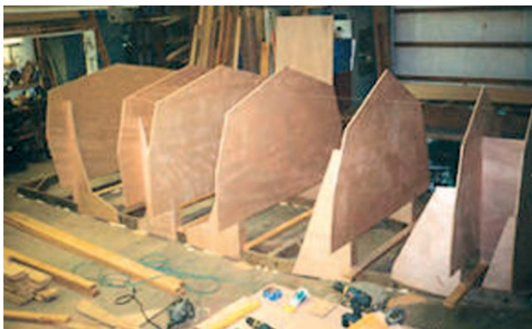
Рис.2. На стапельную раму выставлены фанерные шпангоуты, пока без необходимых вырезов
