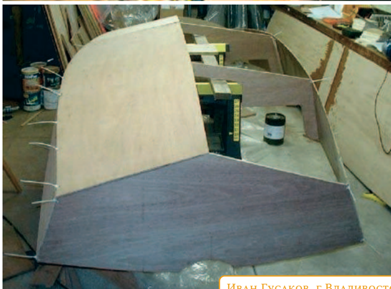
Рис.3. Листы обшивки сшиваются временными скрепками
