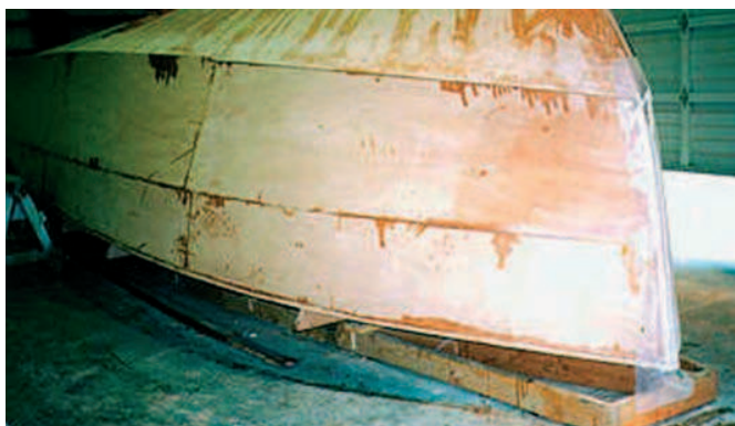
Рис.4. Шитый и проклеенный корпус готов к отделке
