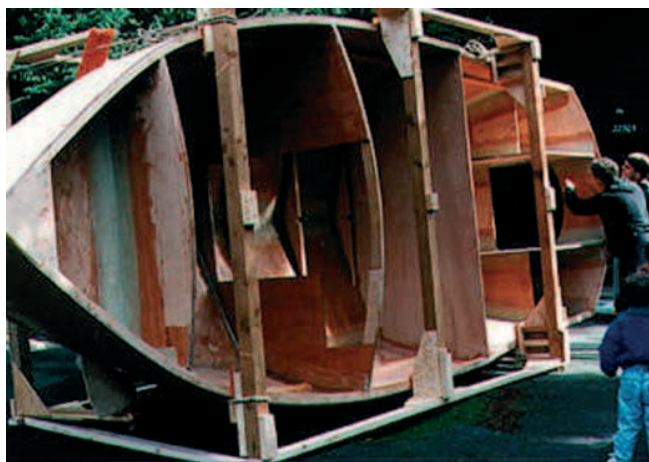
Рис.5. Кантовка наполовину готового корпуса производится с помощью простейших приспособлений
