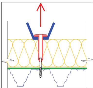
– Основание в кровельных системах с механическим креплением должно обеспечивать достаточное сопротивление вырыву. Простой способ проверки несущей способности основания на строительной площадке – закрепите механически полосу мембраны **V-PP** шириной **50 мм** и приложите к ней вертикальное вырывающее усилие.
