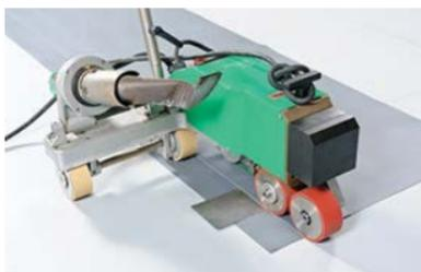
– Со стороны нижнего края заготовки приварите полосу для кармана по длине с помощью автоматического оборудования.
