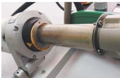
– Снимите охлаждаемую защиту нагревательного элемента вместе со слюдяной вставкой.
