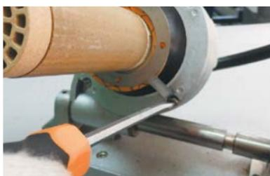
– Открутите 4 винта крепления прижимной пластины.
