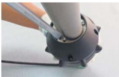
– Открутите 4 винта вокруг защиты нагревательного элемента.
