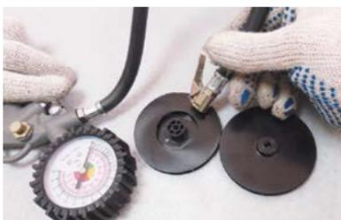
– Две крыльчатки и пластиковую вставку продуйте сжатым воздухом.
