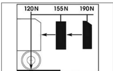
– Кроме скорости и температуры можно изменять еще один параметр сварки – общее давление на шов, которое зависит от веса грузов, установленных на сварочном аппарате.
