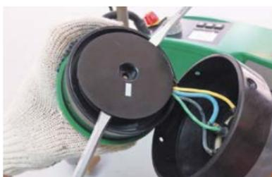
– Открутите гайку крепления верхней крыльчатки электрического мотора и с помощью двух отверток снимите ее с вала.
