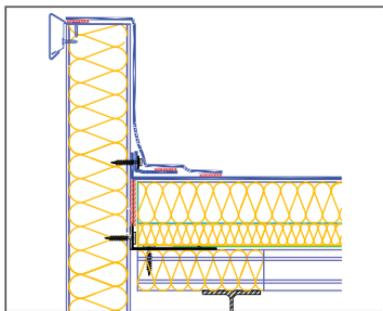
– Либо установите капельник из ламинированного ПВХ металла. О работе с ПВХ металлом см. п. 8.2.
