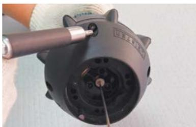
– Открутите 4 винта по периметру корпуса верхней крышки.
