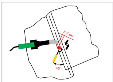
**❗ ВАЖНО!** Сварка шва ручным оборудованием за «три прохода» распространяется на устройство всех швов и выполнение всех деталей на кровле.
