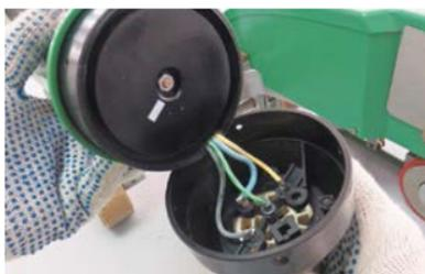
– Отведите верхнюю часть вместе с нагревательным элементом. Нагревательный элемент на данном этапе не снимаем, это может привести к поломке датчика температуры!
