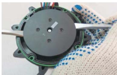
– С помощью двух отверток аккуратно снимите крыльчатку с вала.
