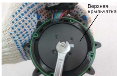
– С помощью гаечного ключа открутите гайку крепления верхней крыльчатки электрического мотора.
