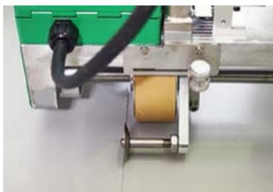
– Металлический направляющий ролик в опущенном положении должен быть расположен вдоль кромки сварочного шва.
