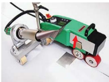
– Для получения ровного края, облегчающего доваривание шва вручную, в начало шва вставьте металлическую пластину с обработанными краями толщиной **0,3 – 0,5 мм** из оцинковки или нержавеющей стали.
