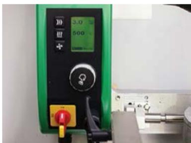
– Перед началом сварочных работ выставьте параметры (температуру воздуха, скорость движения сварочного аппарата).
