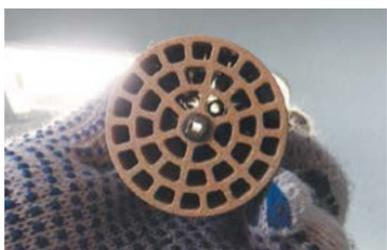
– Проверьте нагревательный элемент на наличие пыли и грязи. Дополнительно проверьте целостность спирали тестером. При разрыве проволочной спирали замените элемент на новый.
