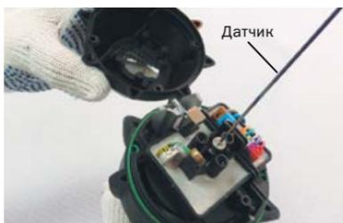
– Снимите верхнюю крышку корпуса. Внутреннюю часть верхней крышки очистите от пыли и грязи при помощи кисти и сжатого воздуха. Аккуратно протрите датчик температуры.
