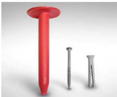
– Для крепления мембраны в основание из бетона класса **B15-B25** или цементно-песчаную стяжку толщиной не менее **50 мм** из раствора не ниже **M150** применяется кровельный остроконечный винт ТехноНИКОЛЬ Ø **4,8 мм** в сочетании с полиамидной анкерной гильзой длиной **45** или **60 мм**.
