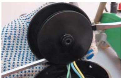
– Достаньте вторую пластиковую крыльчатку электрического мотора с помощью двух отверток.
