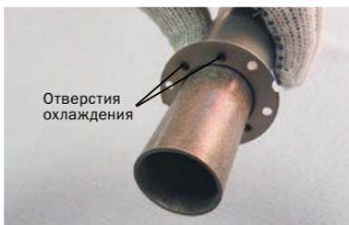
– Освободите от пыли и грязи отверстия в металлической защите и паронитовой проставке. Через них продувается воздух и охлаждается металлическая защита.
