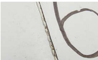
– Мембрана «отлипает» (шов разделяется без усилия), нет когезионного разрыва. Для получения качественного сварного шва уменьшайте скорость сварки, либо увеличивайте температуру сварки.
