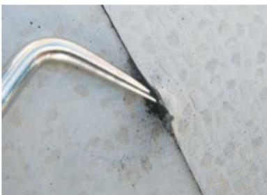
– Последствия попадания несчищенного с сопла нагара в зону сварного шва. Варианты исправления:
