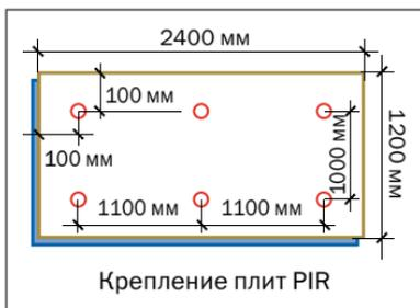
– Необходимо устанавливать не менее двух крепежных элементов на плиту размером **1200x600 мм** или ее части (половина, четверть плиты).
