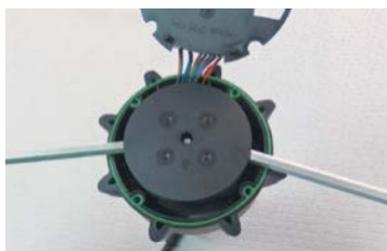
– С помощью двух отверток аккуратно снимите вторую крыльчатку.
