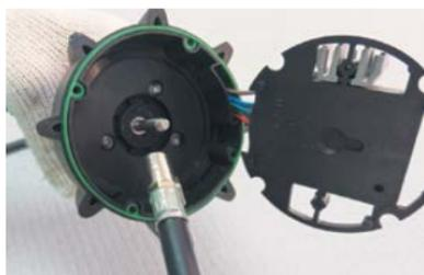
– Удалите пыль и грязь при помощи сжатого воздуха.
