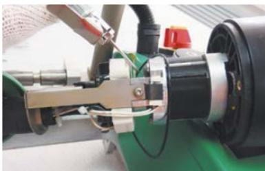
– Очистите от пыли и грязи двигатель фена при помощи сжатого воздуха.
