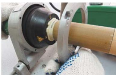
– Снимите прижимную пластину.
