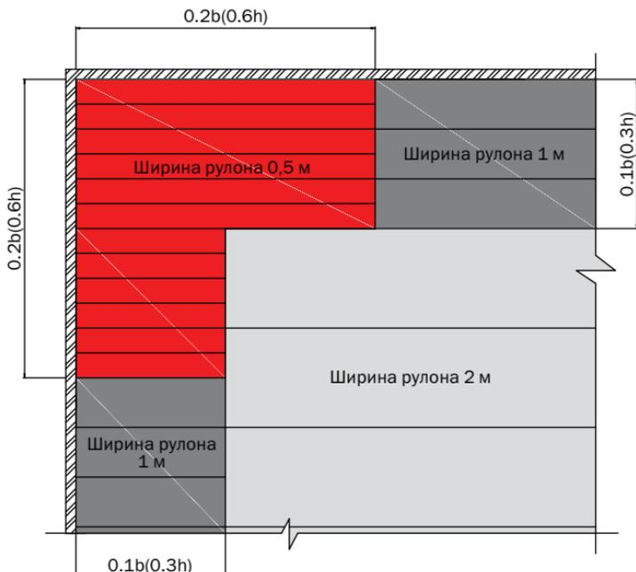
– Для зданий, высота которых больше или равна трети ширины здания ( $h \geq b/3$ ), ширина краевых и угловых зон составляет не менее одной десятой ширины здания (**0,1b**).
