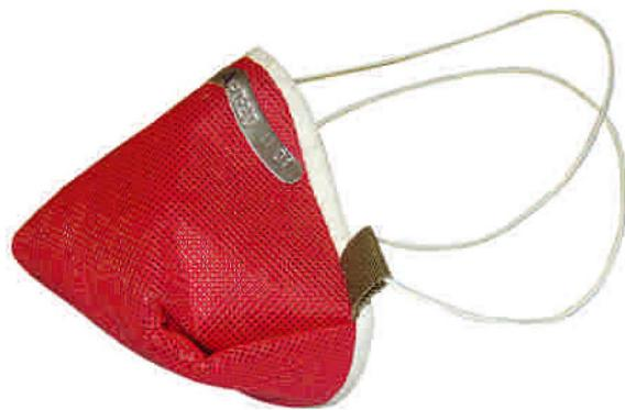
**Назначение.** Полумаска предназначена для защиты от различных аэрозолей при концентрации не более 100 мг/м<sup>3</sup>, паров ртути при концентрации до 1 ПДК, объемном содержании кислорода в воздухе не менее 17 % и положительной температуре воздуха не выше плюс 40°C.
