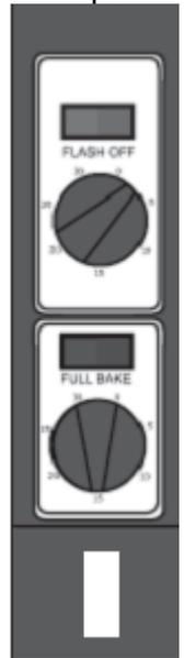
Лампа FLASH OFF горит, когда сушка работает в половину мощности. Таймер FLASH OFF контролирует продолжительность сушки в половину мощности 0-30 минут.
