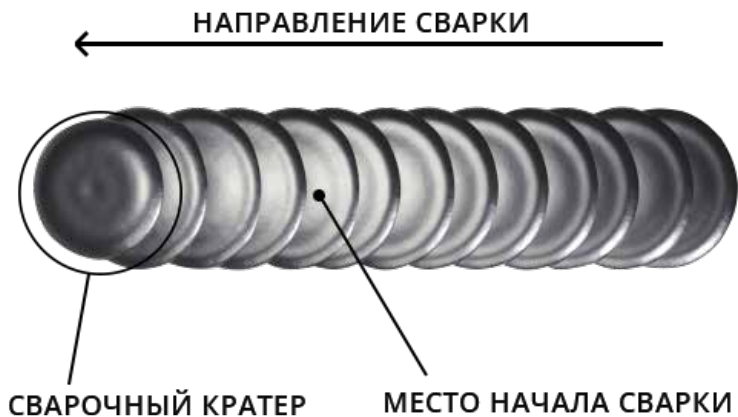
Рис. 12.4. Начало сварки при смене электрода.
