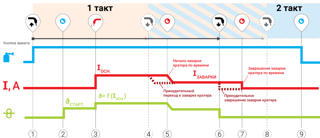
Рис. 29 — Диаграмма работы в двухтактном режиме с ограничением времени
