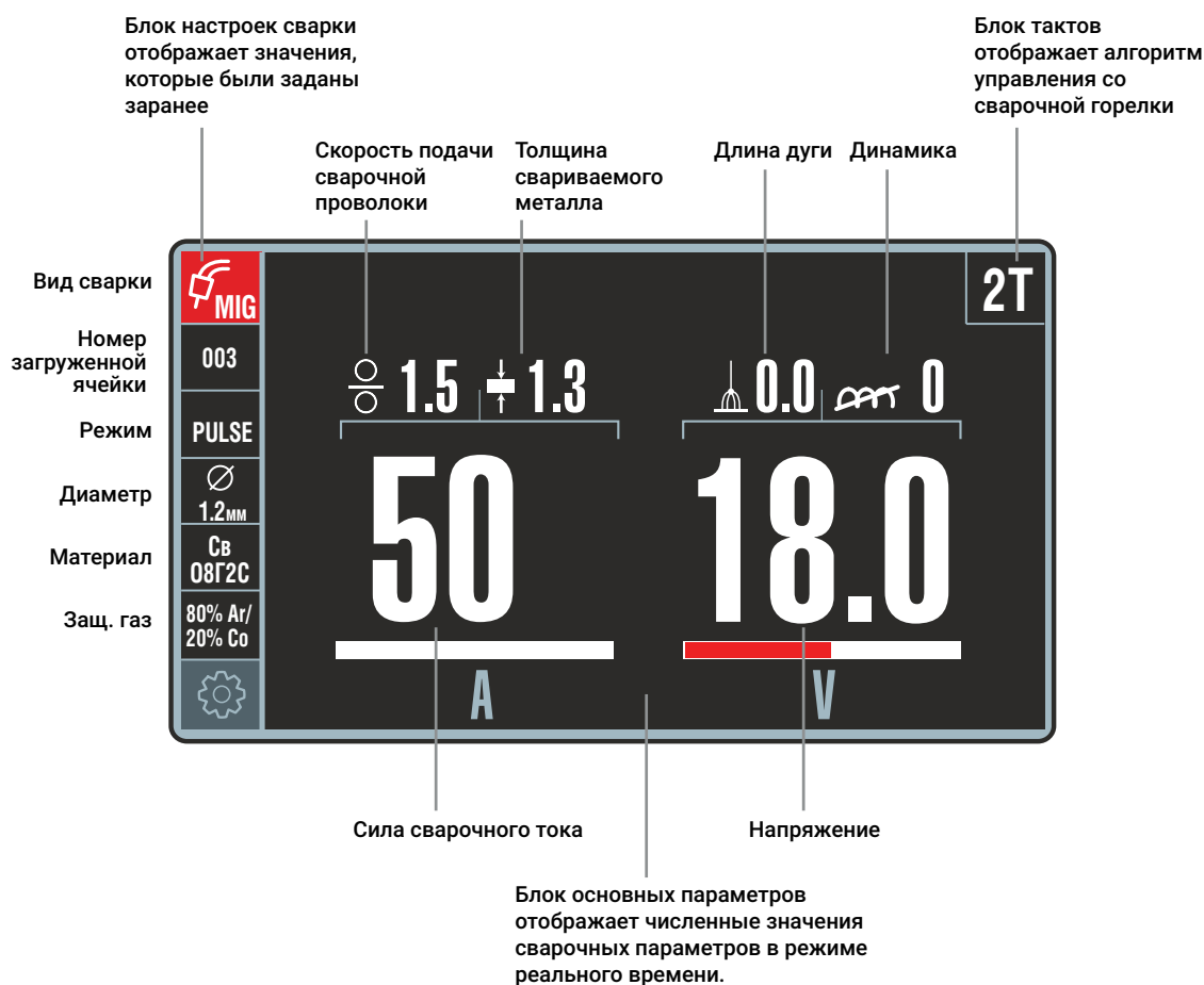
Рис. 16 — Блоки Главного экрана панели управления
