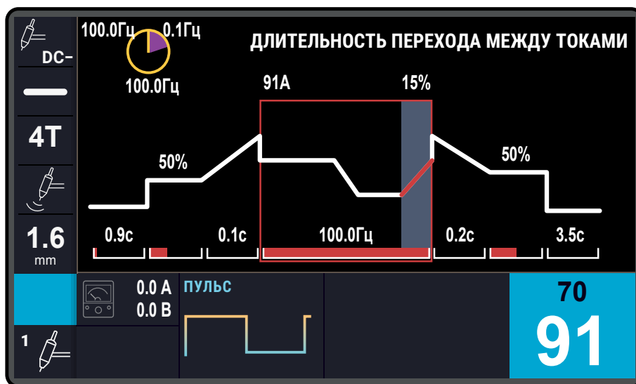
Рис. 21 — Изменение длительности перехода между токами при активированном параметре БАЛАНС
