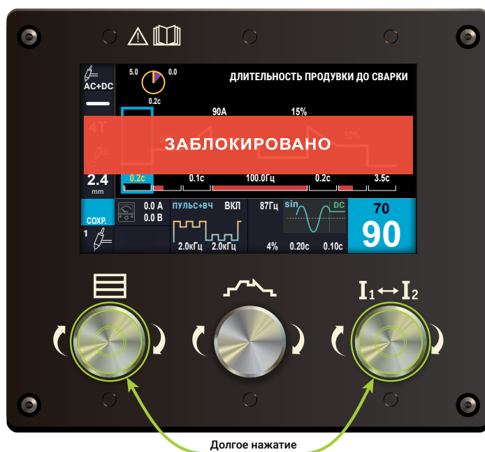
Рис. 12 – Принцип блокировки панели управления
