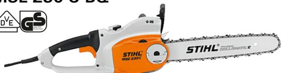
**230 В, 2,3 кВт, 4,8 кг<sup>Ⓞ</sup>**. Мощная электропила для деревянного строительства. Устройство быстрого натяжения цепи STIHL для лёгкого и быстрого подтягивания пильной цепи без инструмента, цепной тормоз QuickStop Super, пильная цепь, моментально останавливающаяся при отпуске задней рукоятки, мягкая рукоятка для комфортного ведения, светодиодный индикатор защиты от перегрузки.
