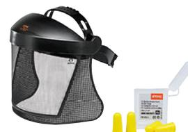
С сеткой из пружинной стали, двумя регулируемыми лентами крепления и 4 берушами. EN 352, EN 1731, SNR 33 (H: 32; M: 29; L: 29) (до 113 дБ(A)).<sup>①</sup>
