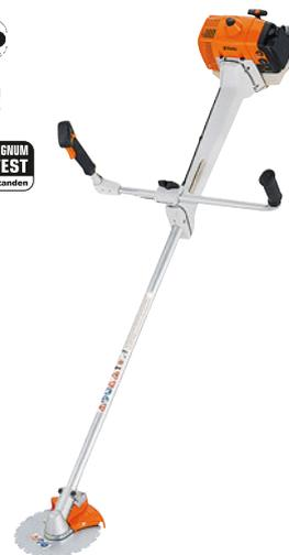
**44,3 см<sup>3</sup>, 2,1 кВт/2,9 л.с., 8,0 кг<sup>⓪</sup>.** Кусторез с высоким режущим усилием с прямой штангой и неразъёмным сплошным валом. Четырёхточечная антивибрационная система STIHL, пусковое устройство STIHL ElastoStart, мультифункциональная рукоятка, двуручная рукоятка, установка положений рукоятки без помощи инструмента.
