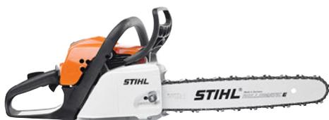
**35,2 см<sup>3</sup>, 1,7 кВт/2,3 л.с., 4,3 кг<sup>①</sup>**. Хорошо подходит для заготовки дров. Система бокового натяжения цепи, экономичный двигатель 2-MIX, переключение с летнего на зимний режим для улучшения рабочих параметров при любых условиях, пильная цепь <sup>3</sup>/<sub>8</sub>" РМЗ для хорошей производительности пиления.
