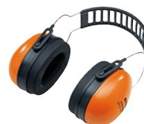
Прочная воздухопроницаемая металлическая дуга. Подушечки для комфортного ношения. EN 352, SNR 28 (H: 31; M: 26; L: 19) (до 108 дБ(A)).
