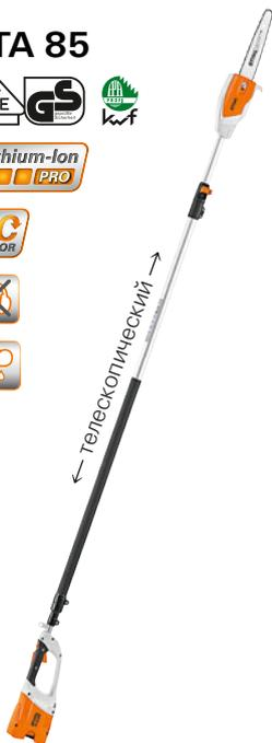
Аккумуляторный высоторез для садоводства и профессионального ухода за деревьями с телескопическим штоком. Лёгкий и мощный, с пильной цепью 1/4" PM3 для особо точного врезания и хорошей производительности пиления, с низким уровнем вибрации и шума для использования в условиях города. Устройство бокового натяжения цепи и нетеряемая гайка в крышке цепной звёздочки, общая длина 270–390 см, вес 4,9 кг<sup>④</sup>. Подробное описание комплектации и технические характеристики см. на стр. 49.
