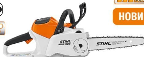
Обновлённая аккумуляторная мотопила для использования в местах с нормированным уровнем шума (наушники не требуются). На 17 % более высокая производительность пиления по сравнению с предыдущей моделью, устройство быстрого натяжения цепи STIHL, цепной тормоз QuickStop Super, открываемая без инструмента крышка масляного бака, пыльная цепь 1/4" PM3 для чистых пропилов и высокой производительности пиления, вес 3,1 кг<sup>②</sup>.
