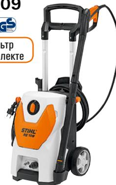
**10–110 бар, 440 л/ч, 17,7 кг.** Мойка для комфортной работы. Алюминиевая телескопическая ручка, откидная передняя крышка со встроенным отсеком для хранения форсунок, вращающийся держатель сетевого кабеля, быстросъёмная муфта для шланга высокого давления, напорный шланг в текстильной оплётке длиной 7 м.
