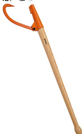
Вес ок. 3600 г. Для перекалывания стволов, особенно подходит при заготовке крупномерной древесины. Зубчатая насечка, коническая втулка, ручная ковка крюка и рукоятка из ясеня.
