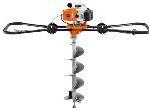
**60,3 см<sup>3</sup>, 2,9 кВт/3,9 л.с., 28,8 кг<sup>①</sup>**. Надёжный двигатель с высоким крутящим моментом, предназначенный для сложных работ по бурению в паре (для двух человек). Серийно оснащён пусковым устройством STIHL ElastoStart, блокировкой шнека, усиленным фильтром, карбюратором с компенсатором, дополнительной кнопкой остановки для второго пользователя, складной рамой.
