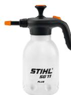
Ручной распылитель с регулируемой форсункой для нанесения растворителей и очистителей, например, средств СВ 90 или Varioclean. Объём бака 1,5 л, макс. давление 3 бара, уплотнения EPDM для растворителей и очистителей с уровнем pH 7-14. Насос оснащён специальным защитным элементом для долгого срока службы.
