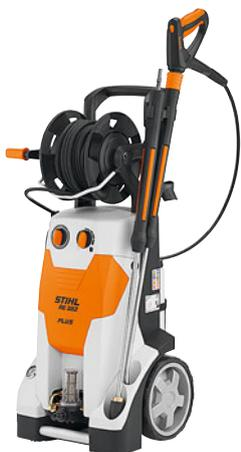
**60–160 бар, 760 л/ч, 42,0 кг.** Мойка повышенной комфортности с высокой мощностью. Низкооборотный двигатель, барабан для намотки шланга с дополнительным сматывающим приспособлением, шланг высокого давления в стальной оплётке длиной 15 м, вторая распылительная трубка с роторной форсункой, напряжение сети 400 В, износостойкие поршни с керамическим покрытием, эргономичный профессиональный пистолет STIHL, бак для моющего средства, регулятор давления/расхода, манометр, большой водяной фильтр.
