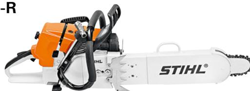
**76,5 см<sup>3</sup>, 4,4 кВт/6,0 л.с., 7,2 кг<sup>Ⓛ</sup>**. Пила для аварийно-спасательных работ и борьбы с пожарами. Рукоятка на ограничителе реза для быстрой и простой регулировки глубины пиления, большая пусковая рукоятка и декомпрессионный клапан для простого и безопасного запуска двигателя пилы, специальная пильная цепь с наплавленными твердосплавными пластинами с высокой ударной прочностью.
