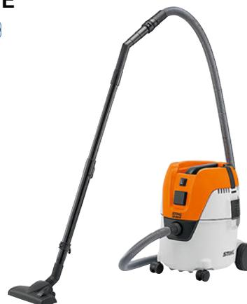
**1,4 кВт, 210 мбар, 3600 л/мин.** Розетка с функцией автоматического включения (E) для подсоединения электроинструментов. Возможность как сухой, так и влажной уборки, функция выдувания за счёт перестановки всасывающей трубки, многоступенчатая система фильтрации, система очистки фильтра, всасывающий шланг длиной 3,5 м, телескопическая всасывающая трубка, переключаемая насадка для пола, универсальная насадка, щелевая насадка, переходник для электроинструмента.
