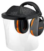
С дугой с мягкой подкладкой и наушниками. С увеличенным щитком. Внутреннее стекло с покрытием против запотевания. Дополнительная защита лба. EN 166, EN 352, SNR 30 (H: 34; M: 27; L: 18) (до 110 дБ(A)).<sup>②</sup>
