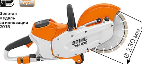
Удобное абразивно-отрезное устройство с абразивным отрезным кругом диаметром 230 мм для реза с подключением к воде. Возможность использования как внутри, так и вне помещений, глубина реза до 70 мм, подключение к источнику воды с помощью быстроразъёмной муфты, кран для регулировки подачи воды, фиксатор шпинделя для смены отрезного круга без инструмента, не требующий обслуживания ремень, вес 3,9 кг<sup>③</sup>. Подробное описание комплектации и технические характеристики см. на стр. 175.
