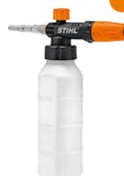
Высокая эффективность очистки благодаря долго не опадающей пене. Вертикальная или горизонтальная регулировка распыляемой струи, регулировка угла распыления, дозировка концентрированного моющего средства, 1-литровая бутылка с большим заливным отверстием, для моделей RE 232 – RE 462.
