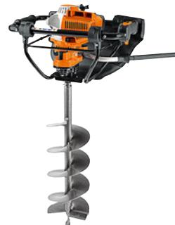
**36,3 см<sup>3</sup>, 1,4 кВт/1,9 л.с., 9,9 кг<sup>①</sup>**. Ручной бензобур, обслуживаемый одним человеком, двигатель 4-MIX® с низким расходом топлива, с низкими звуковыми показателями и показателями вибрации, серийно оснащён системой быстрого торможения бура QuickStop, бумажным фильтром с долгим сроком службы, карбюратором с компенсатором и подушкой.
