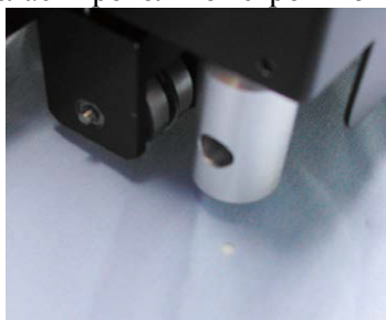
Рис. 1: Специальный инструмент сверла делает проколы быстро и точно
