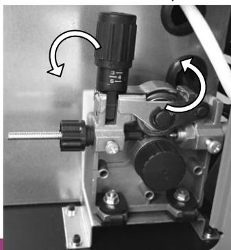
4.1.2.2 Проверьте, что профиль приводного ролика (21) соответствует выбранному типу и диаметру проволоки. Приводной ролик имеет две канавки различного размера, размер используемой канавки отпечатан на боковой стороне приводного ролика. Для «мягкой» самозащитной проволоки с флюсом, например, используемой в безгазовой сварке MIG, канавка приводного ролика имеет зазубренную канавку. Для сплошной «твердой» проволоки MIG используется ролик с V-образной канавкой
