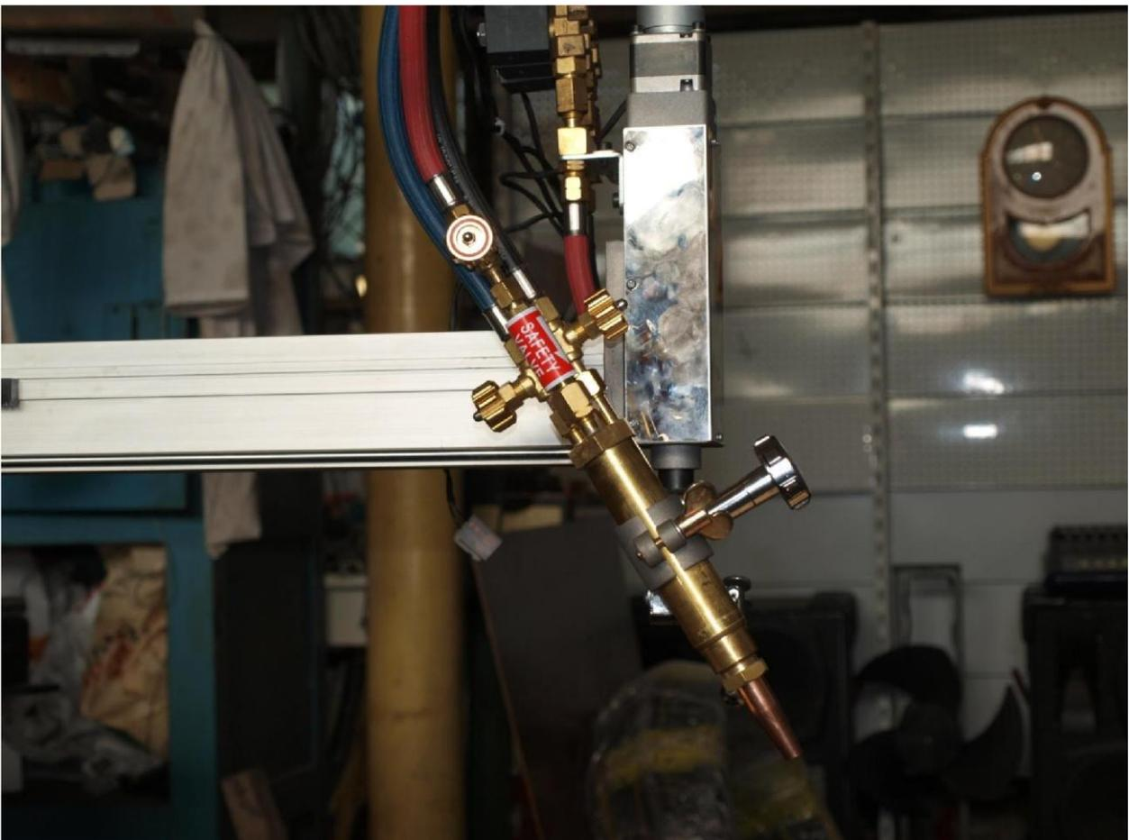
ФОТО №3 (резак газовый снят и устанавливается в приспособление, чтобы не болтался)
