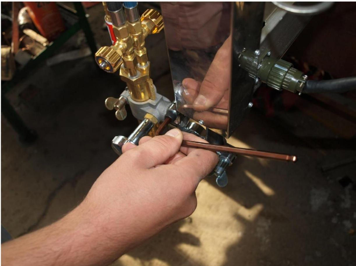
**№2 (если не снимать резак газовый, то открутив, можно повернуть и закрепить резак для резки под фаску, как на фото, либо снять, как на фото №3)**
