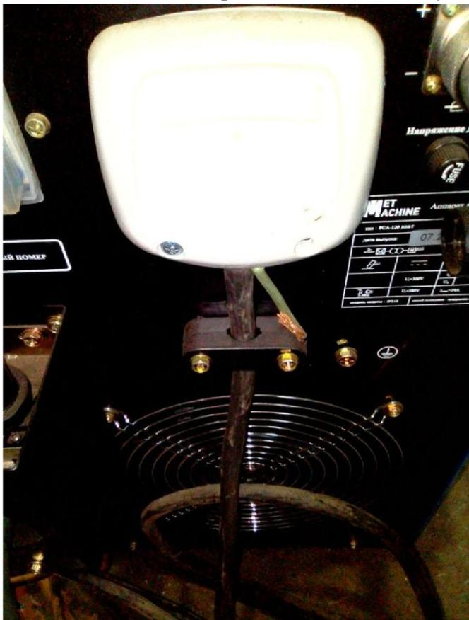
№3 Подключение источника к ЧПУ (данные провода идут от ЧПУ, правое подключение идет на включение источника, левое идет к измерителю напряжения дуги. В самом ЧПУ эти два провода подключены через один разъем)
