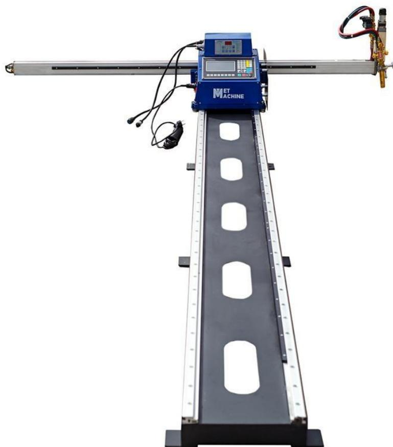
**Узел крепления резаков с установленным газовым резаком (не подключенные шланги на фото крепятся к выводам, закрытым желтыми резиновыми колпачками в соответствии с цветом шланга, газ к газу (красный), кислород к кислороду (синий)):**
