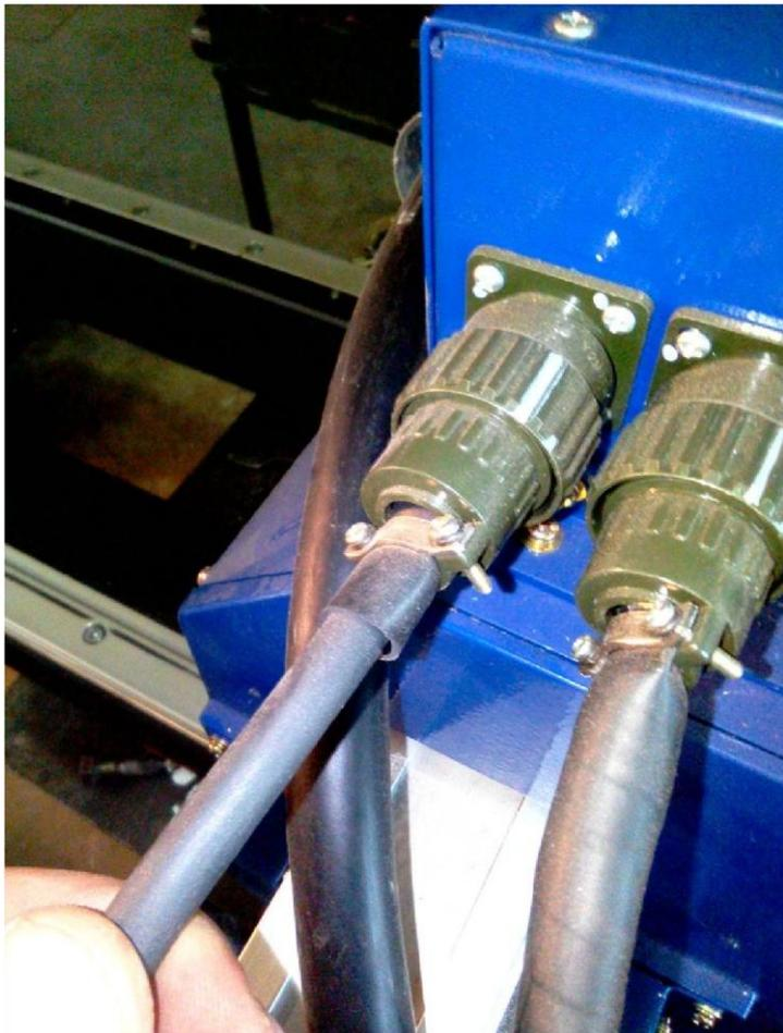
**№6 Два средних разъема идут к голове ЧПУ (там не перепутаешь разъемы, защита от «дурака»), правый – от штанги, отвечает за датчик начальной высоты, управление клапанами газовой резки, а так же механизмом опускания/поднимания резака**
