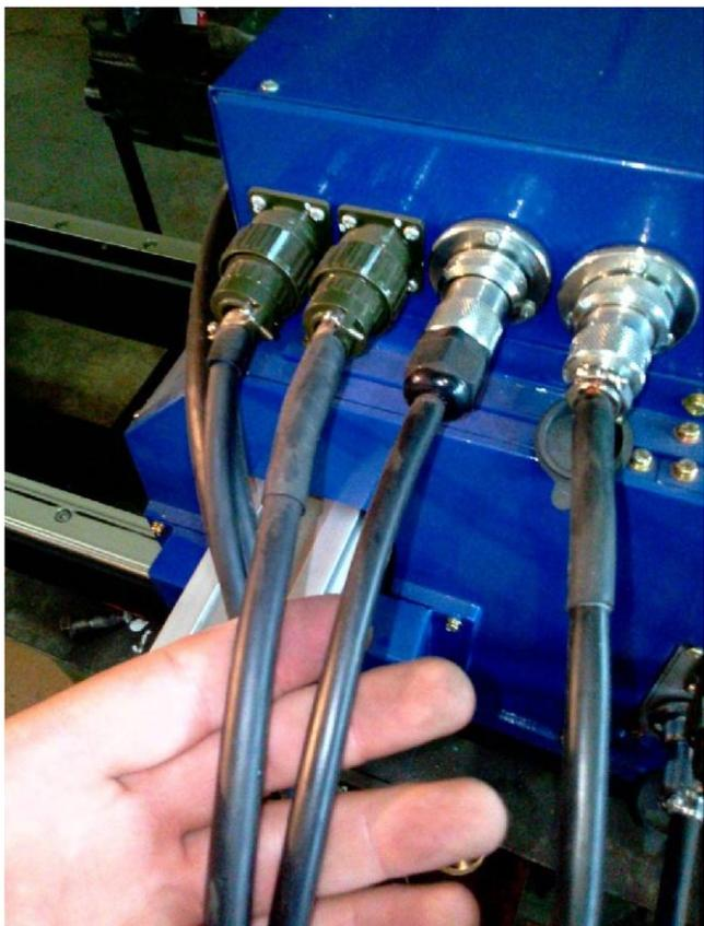
Здесь подключены два противоположных конца проводов средних с картинки сверху. На картинке снизу разъем с надписью Input Power – это питание 220В для самой машинки ЧПУ
