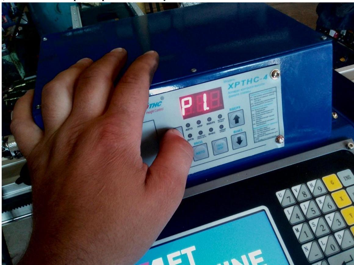
... и возвращаемся в рабочий режим с уже измененными настройками (в данном случае меняли напряжение дуги со 125В на 123В, с остальными параметрами так же):
