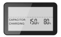
Внимание! Не заряжайте устройство, если ваш автомобильный аккумулятор имеет слишком низкий остаток энергоёмкости (меньше 15%) и низкое напряжение (ниже 9В). Нужно зарядить конденсатор от аккумулятора другого автомобиля.
