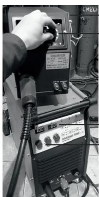
При использование синергетического режима необходимо задать все параметры сварки: диаметр проволоки, сварочный газ, режим 2Т или 4Т.
