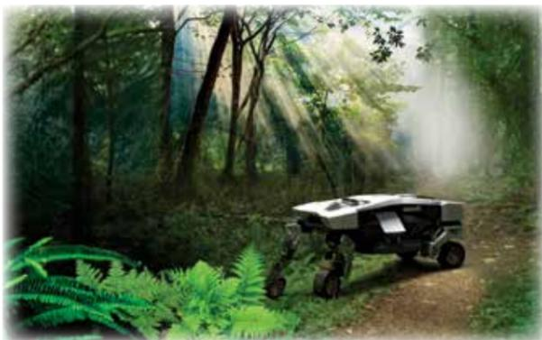
но-сочлененном подрамнике. Это позволяет машине перешагивать препятствия. Также вездеход способен разворачиваться на месте на 360 градусов и ездить боком под любым углом: колеса могут поворачиваться независимо друг от друга.
