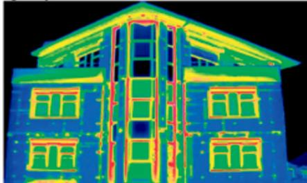
Обследование тепловизором дома из полистиролбетона
