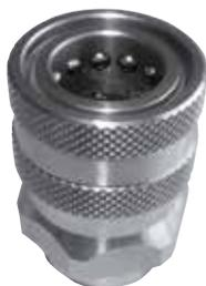
Быстроразъемное соединение из нержавеющей стали AISI 316, max 200 бар, 100°C, 1/2" (внутренняя резьба).
