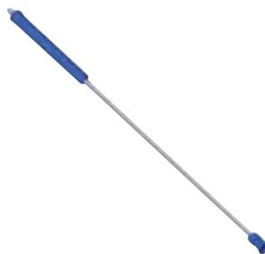
Копье из нержавеющей стали с синей ручкой. С держателем форсунки 1/4" (внутренняя резьба) и БРС 4904 (наружная резьба) на входе. 200 бар, 40 л/мин. Длина 1 м.
