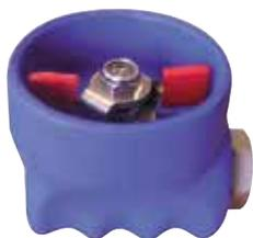
Шаровой кран из нержавеющей стали с защитой из резины, max 60 бар, 95° С. Внутренняя резьба + внутренняя резьба 1/2".
