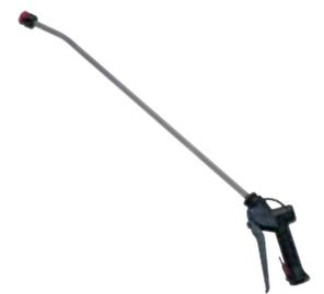
Копьё для пены из нержавеющей стали, с внутренними компонентами из нержавеющей стали и Viton™, с пластиковой форсункой (вход 1/2", внутренняя резьба).
