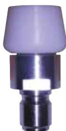
Пенная насадка из нержавеющей стали с белой защитой, форсунка 50°, 200л/мин при 20 бар.
