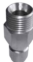
Быстроразъемное соединение из нержавеющей стали AISI 316, max 200 бар, 100°C, 1/2" (наружная резьба).
