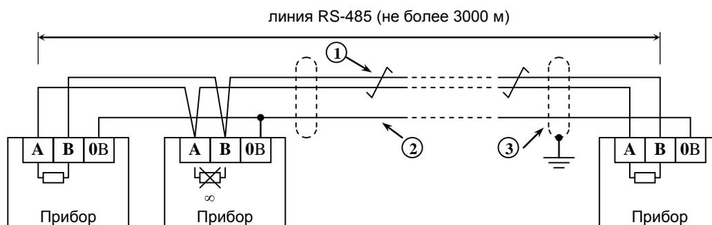
**Прибор** – прибор ИСО «Орион», имеющий возможность подключения к пульту «С2000М» посредством интерфейса RS-485 (до 127 шт.) или пульт «С2000М» (не более 1 шт.);
