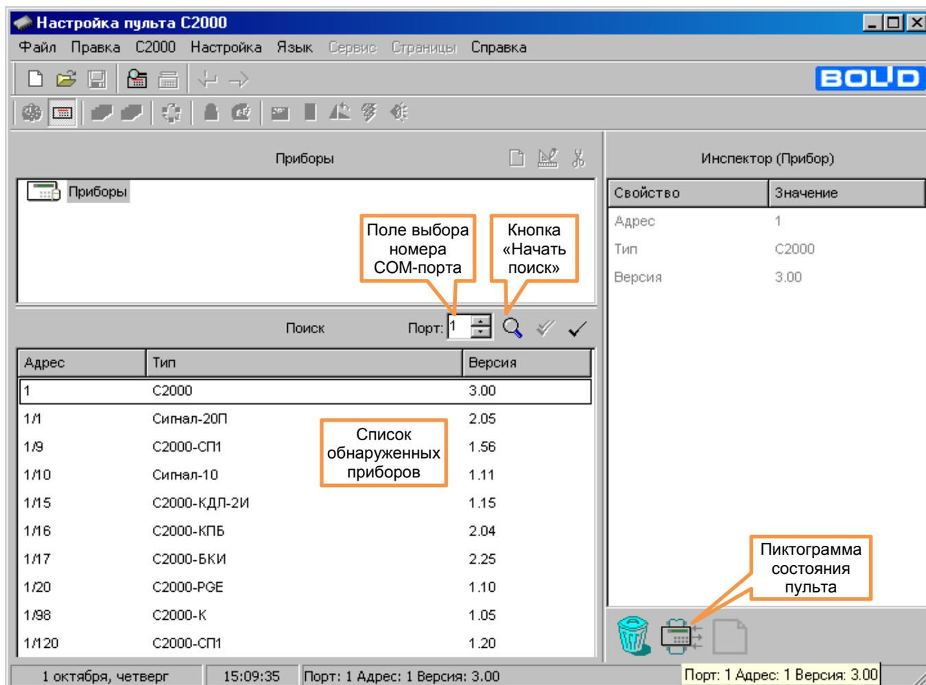
**Рисунок 15** Поиск подключенных пультов и приборов
