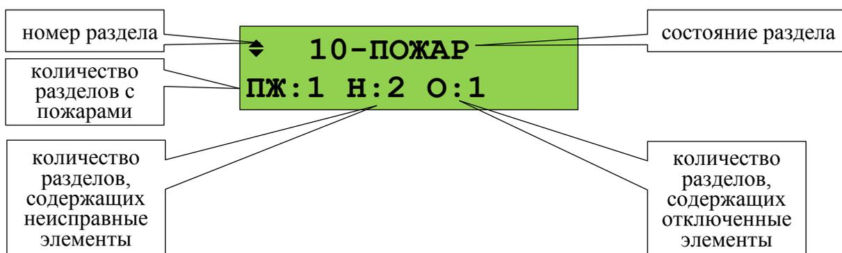
В нижней строке экрана отображается количество зон (разделов) с пожарными тревогами (ПЖ), охранными тревогами (ТР), запущенными противопожарными устройствами (ЗАП), остановленными противопожарными устройствами (ОСТ), неисправными (Н) и отключенными (О) элементами.
