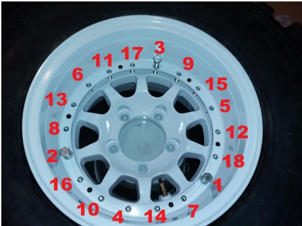
24. Вывернуть крепеж, использованный для стяжки ободьев (1, 2, 3). Вкрутить в свободные отверстия (1, 2, 3) с внутренней стороны диска винты М10 с внутренним 6-гранником с шайбами и затянуть моментом 50Нм (5кгсм). Для этого может понадобиться снять колесо с подставки.
