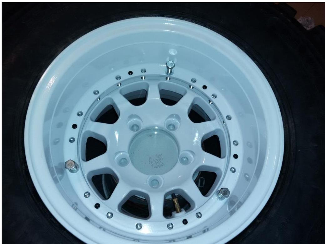
21. Равномерно заворачивая (винты) болты, стянуть половинки колеса. **Контролировать посадку обода на ступицу. Не допускать перекосов. Не применять**
