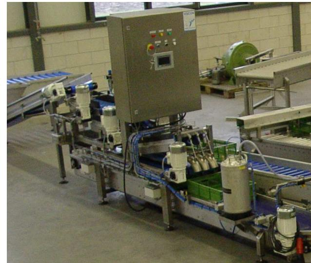
Бережное обращение с цыплятами при подсчете – важный фактор и залог получения качественного продукта. В связи с этим все скорости конвейеров и расстояние, которое пролетают цыплята при попадании в ящик, рассчитаны, и нахождение цыплят в стрессовом состоянии сведено к минимуму.
