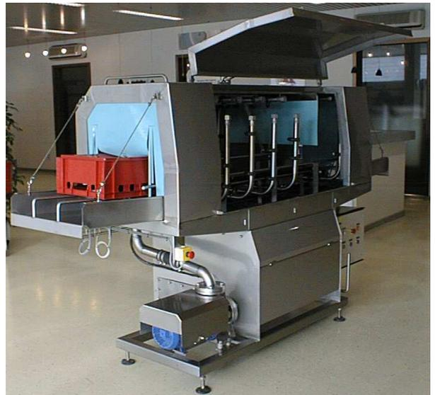
Возможно изменение скорости вращения транспортной цепи машины. Таким образом можно изменять время нахождения корзины внутри секции мойки и, следовательно, производительность машины.
