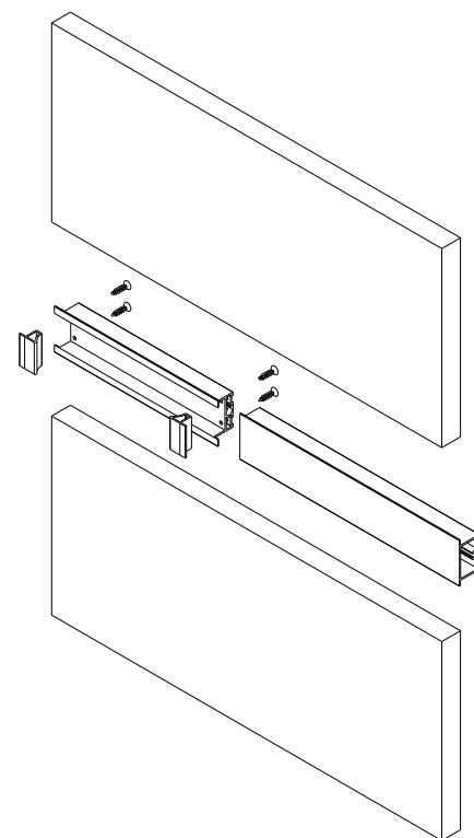
**5** Для соединения деталей полотна двери используйте соединительную пластину (ANV16-05) с интервалом 300-400 мм.
