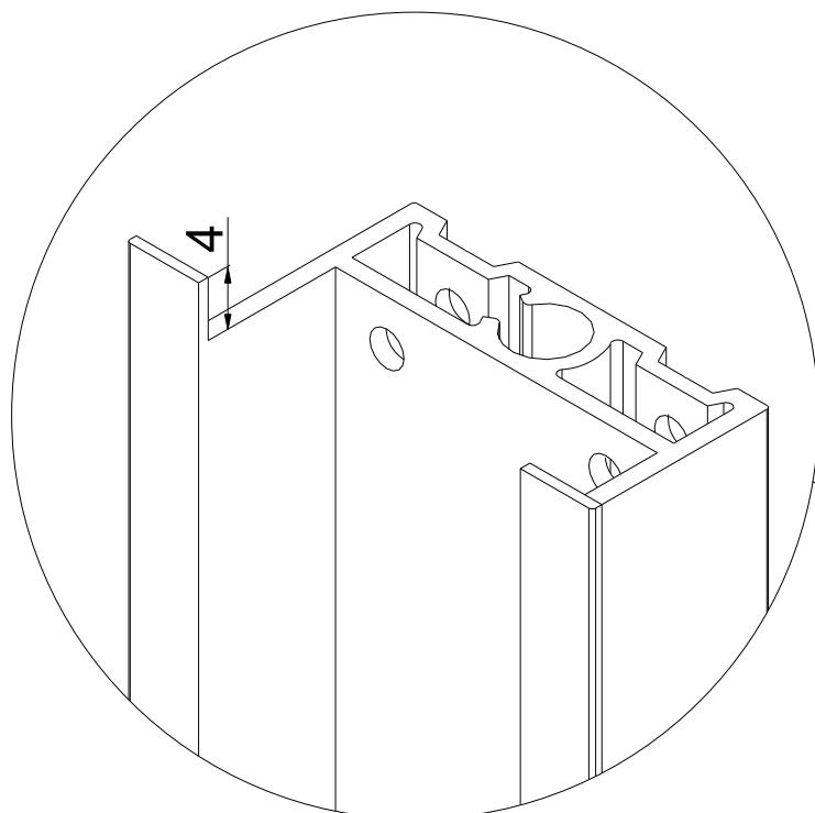
Используем саморез 2,9\*13 мм с потайной головкой.
